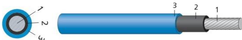
Слика 6.4. Једножилни соларни кабл, 1 – финожични бакарни проводници, 2 – изолациони слој, 3 – омотач у боји
